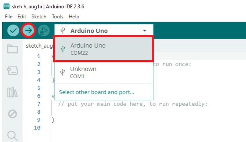
Figura 1.2: Selecionando a placa e porta na IDE do Arduino
